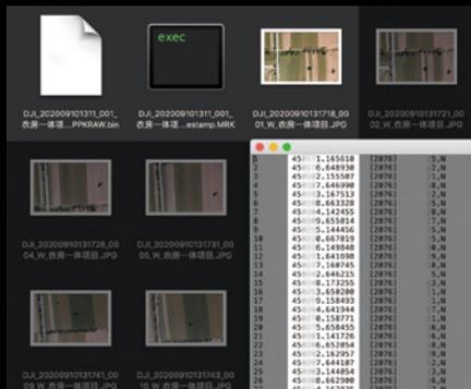
相机内参、外参、RTK 状态等信息自动写入照片
